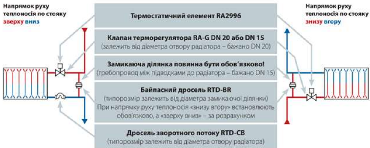
Рисунок 4.13 - Схема радіаторного регулювання для однотрубно́ї системи
