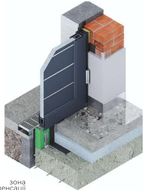
Рис.19 Нижній вузол примикання зовнішніх дверей та його оптимізація
