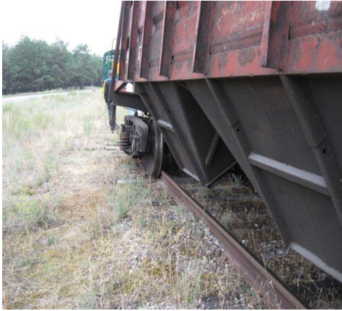
Фото. 5.3.2.6, 5.3.2.7. Транспортна подія, яка сталася 17.06.2015 Новокаховській філії, на колії № 1 маневровий район 1-й, де при виконанні маневрових робіт локомотивом ТГМ-4 № 2425 з 7-ми вагонами-зерновозами завантаженими соєю, стався схід 4-го вагону чотирма колісними парами та 5-го вагону двома колісними парами першого візка за напрямком руху
