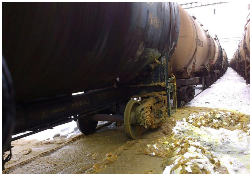
Фото. 7.1.1. Аварійна ситуація, яка сталася 02.01.2015 на станції Одеса-Пересип Одеської залізниці, в результаті якої виявлено витікання газойлю
