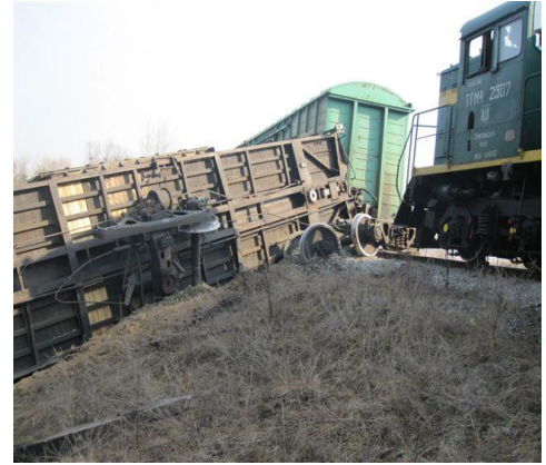
Фото. 5.3.2.2. Транспортна подія, яка сталася 20.03.2015 на Трипільській філії, де при виконанні маневрової роботи локомотивом ТГМ-4 № 2507 з 11-ма вагонами (вантаж – целюлоза), стався схід першого по напрямку руху вагона всіма колісними парами з подальшим падінням на бік (рух здійснювався локомотивом вперед
