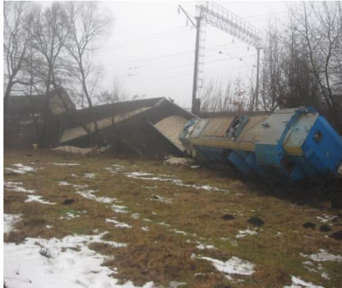
Фото. 5.3.2.1. Аварія, яка сталася 24.01.2015 на Тернопільській філії, де під час проведення маневрової роботи маневровим локомотивом ТЕМ-2У № 9257 з 7-ми напіввагонів завантажених щебенем стався схід локомотива і 3-х вагонів з подальшим їх падінням (перекиданням) на бік (з втратою вантажу) та схід одного вагона однією колісною парою першого візка
