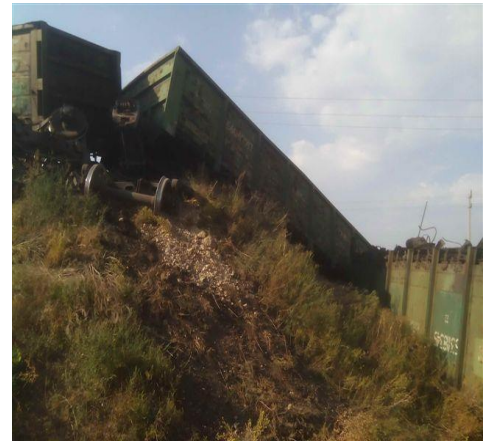
Фото. 5.3.2.8, 5.3.2.9. Транспортна подія, яка сталася 17.06.2015 Новокаховській філії, на колії № 1 маневровий район 1-й, де при виконанні маневрових робіт локомотивом ТГМ-4 № 2425 з 7-ми вагонами-зерновозами завантаженими соєю, стався схід 4-го вагону чотирма колісними парами та 5-го вагону двома колісними парами першого візка за напрямком руху
