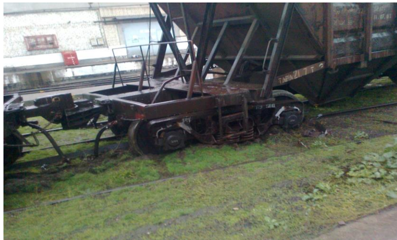
Фото. 5.3.2.10. Транспортна подія, яка сталася 24.11.2015 на Херсонській філії де при виконанні маневрових робіт локомотивом ТЕМ-2 № 3042 з 7-ми завантаженими вагонами (вантаж – зерно) на колії №14 при русі по непідготовленому маршруту, стався розріз стрілочного переводу № 77, в наслідок чого допущено схід 2-х вагонів: одного другим візком по ходу руху, другого - першим візком по ходу руху (без пошкодження вантажу)
