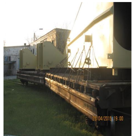
Фото. 5.3.2.3, 5.3.2.4. Транспортна подія, яка сталася 25.04.2015 на Новокаховській філії, на тупиковій колії № 8 маневровий район 3-й, де при виконанні маневрових робіт локомотивом ТГМ-4 № 2425 з 3-ма вагонами (платформи) з вантажем (металоконструкції), стався схід третьої платформи за напрямком руху, двома колісними парами першого візка (без пошкодження вантажу)
