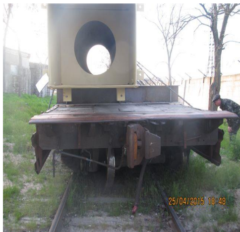
Фото. 5.3.2.3, 5.3.2.4. Транспортна подія, яка сталася 25.04.2015 на Новокаховській філії, на тупиковій колії № 8 маневровий район 3-й, де при виконанні маневрових робіт локомотивом ТГМ-4 № 2425 з 3-ма вагонами (платформи) з вантажем (металоконструкції), стався схід третьої платформи за напрямком руху, двома колісними парами першого візка (без пошкодження вантажу)
