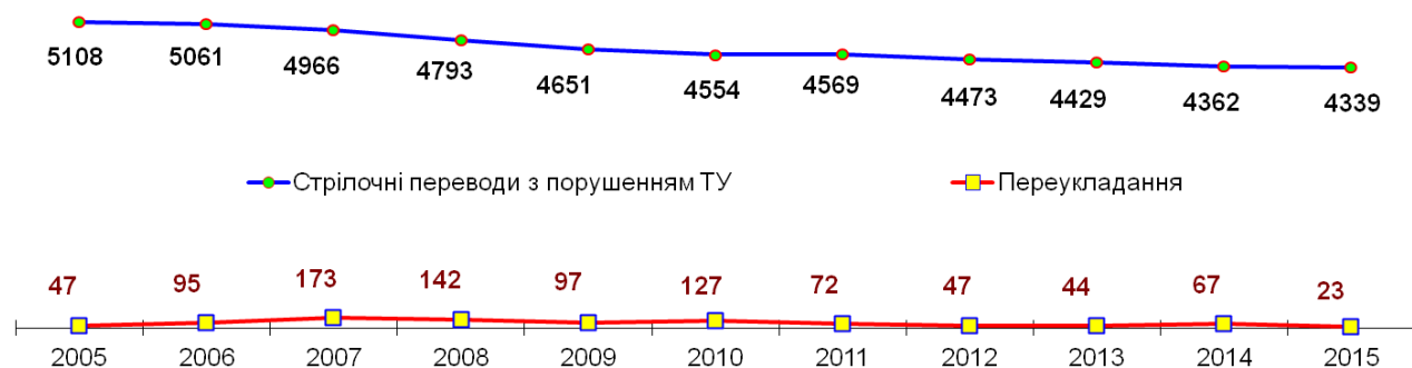
Рис. 5.3.1.26. Кількість стрілочних переводів, вкладених з порушенням ТУ / виконано переукладання протягом 2005 – 2015 років
