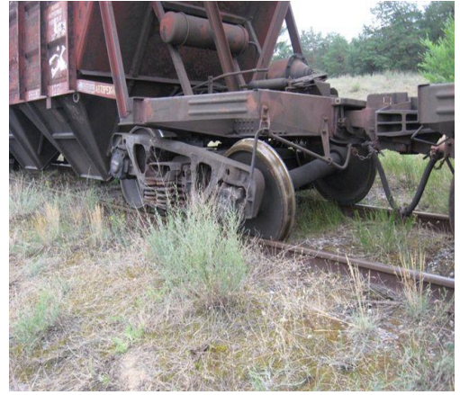
Фото. 5.3.2.6, 5.3.2.7. Транспортна подія, яка сталася 17.06.2015 Новокаховській філії, на колії № 1 маневровий район 1-й, де при виконанні маневрових робіт локомотивом ТГМ-4 № 2425 з 7-ми вагонами-зерновозами завантаженими соєю, стався схід 4-го вагону чотирма колісними парами та 5-го вагону двома колісними парами першого візка за напрямком руху
