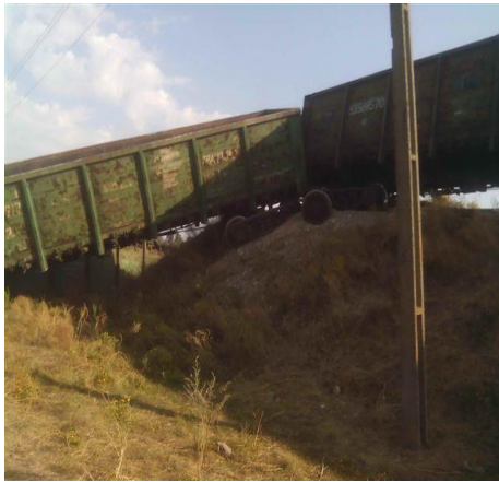
Фото. 5.3.2.8, 5.3.2.9. Транспортна подія, яка сталася 17.06.2015 Новокаховській філії, на колії № 1 маневровий район 1-й, де при виконанні маневрових робіт локомотивом ТГМ-4 № 2425 з 7-ми вагонами-зерновозами завантаженими соєю, стався схід 4-го вагону чотирма колісними парами та 5-го вагону двома колісними парами першого візка за напрямком руху
