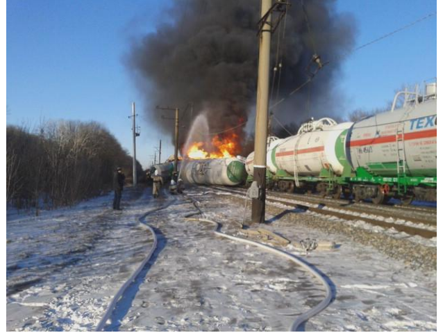
Фото 41, 42. Аварійна ситуація, що сталася 02.02.2014 на перегоні Межова - Удачна Донецької залізниці, де у складі поїзда сталося сходження 26-ти вагонів (вантаж зріджений газ – пропан, бутан, навантаження Кульсари, Республіка Казахстан, КЗХ) з причини технічної несправності вагону № 57869695, власності КЗХ. В результаті втрачено 289,8 т небезпечного вантажу, а матеріальний збиток склав 1949,1 тис. грн.
