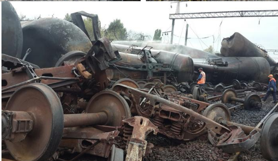
Фото 43, 44, 45. Аварійна ситуація, що сталася 22.08.2014 на перегоні Корсунь - Городище Одеської залізниці, де під час прослідування поїзда №1468 сталося сходження 28-ми вагонів із займанням вантажу нафти сирові, навантаження Дрогобич Львівської залізниці. Причина – технічна несправність вагону №56109481 власності ВАТ «Полтавський ГЗК»
