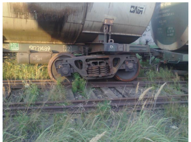
Фото 13. Транспортна подія, яка сталася 22.08.2014 на стрілочному переводі Київ-Дніпровського виробничого підрозділу Товариства при виконанні маневрової роботи локомотивом ТГМ-4Б з 19-а порожніми цистернами, де стався схід 16-ого (за напрямком руху) вагона другим візком двома колісними парами і схід 17-ого (за напрямком руху) вагона першим візком двома колісними парами
