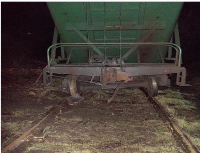
Фото 12. Транспортна подія, яка сталася 11.01.2014 на 9 км ПКЗ П головної колії Прилуцької філії Товариства під час виконання маневрової роботи локомотивом ТЕМ-2 з 4-ма вагонами-зерновозами з вантажем (вантаж – зерно), де стався схід першого та другого (за напрямком руху) вагонів усіма колісними парами
