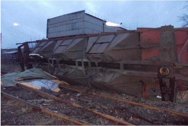
Фото 10, 11. Транспортна подія, яка сталася 10.01.2014 на стрілочному переводі Сумської філії Товариства при виконанні маневрової роботи локомотивом ТГМ-4Б з 4-ма вагонами-зерновозами з вантажем (вантаж – зерно кукурудзи), де стався схід та перекидання першого (за напрямком руху) вагона і схід другого (за напрямком руху) вагона першою колісною парою
