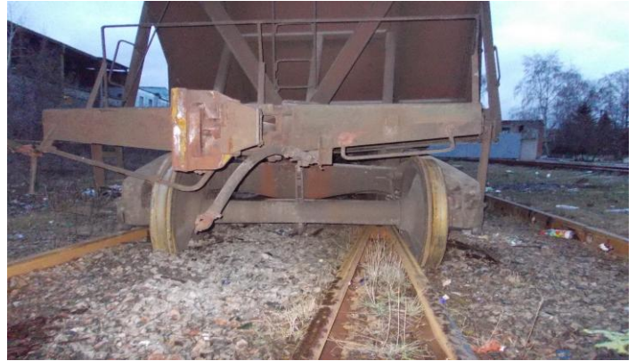
Фото 10, 11. Транспортна подія, яка сталася 10.01.2014 на стрілочному переводі Сумської філії Товариства при виконанні маневрової роботи локомотивом ТГМ-4Б з 4-ма вагонами-зерновозами з вантажем (вантаж – зерно кукурудзи), де стався схід та перекидання першого (за напрямком руху) вагона і схід другого (за напрямком руху) вагона першою колісною парою
