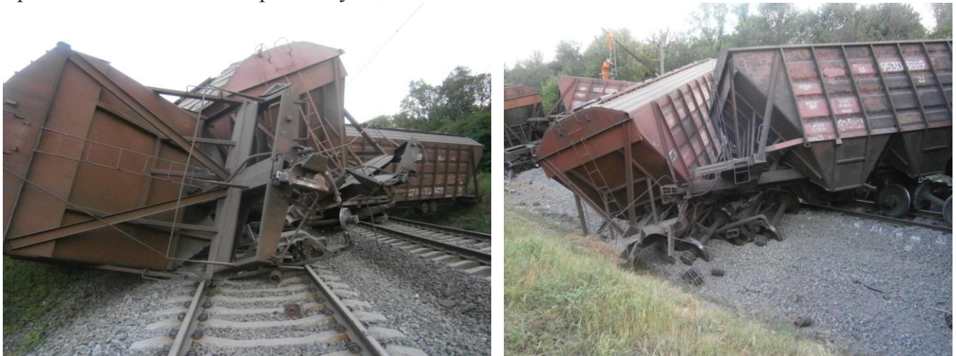
Фото 6, 7. Транспортна подія, яка сталася 17.08.2014 на перегоні Вінниця Вантажна – Сосонка Південно-Західної залізниці, де при швидкості 71 км/год. в поїзді № 2204 допущено схід з рейок 11-и порожніх хопер-зерновозів
