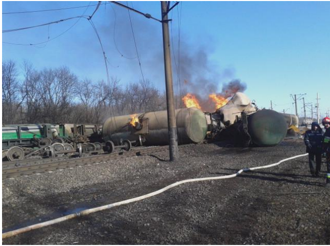
Фото 41, 42. Аварійна ситуація, що сталася 02.02.2014 на перегоні Межова - Удачна Донецької залізниці, де у складі поїзда сталося сходження 26-ти вагонів (вантаж зріджений газ – пропан, бутан, навантаження Кульсари, Республіка Казахстан, КЗХ) з причини технічної несправності вагону № 57869695, власності КЗХ. В результаті втрачено 289,8 т небезпечного вантажу, а матеріальний збиток склав 1949,1 тис. грн.
