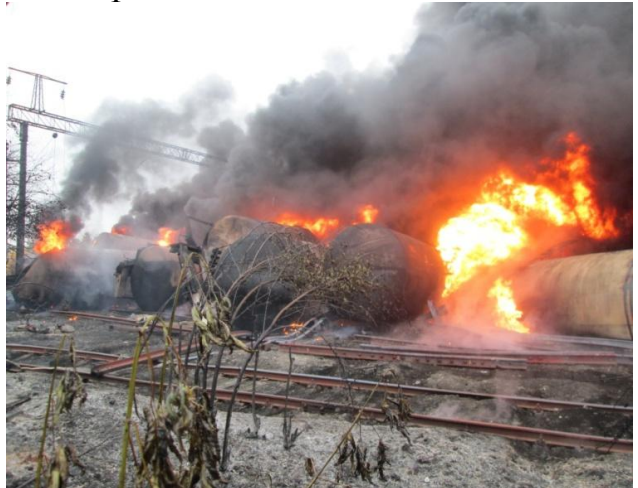
Фото 41, 42. Аварійна ситуація, що сталася 02.02.2014 на перегоні Межова - Удачна Донецької залізниці, де у складі поїзда сталося сходження 26-ти вагонів (вантаж зріджений газ – пропан, бутан, навантаження Кульсари, Республіка Казахстан, КЗХ) з причини технічної несправності вагону № 57869695, власності КЗХ. В результаті втрачено 289,8 т небезпечного вантажу, а матеріальний збиток склав 1949,1 тис. грн.
