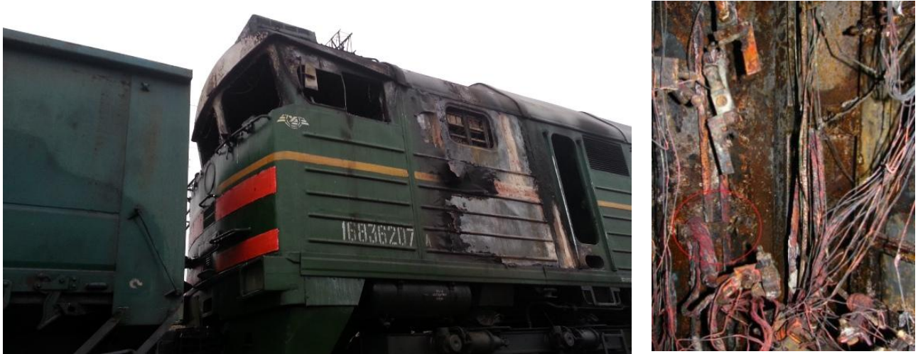
Фото 4, 5. Наслідки пожежі, що виникла на тепловозі 2ТЕ116-1470 через коротке замкнення силових ланцюгів у високовольтній камері внаслідок експлуатації тепловоза без капітального ремонту КР-2 більше 26 років
