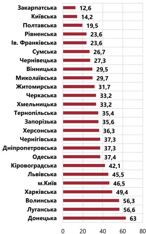
Рис. 3.8. Частка ветхих та аварійних водопровідних мереж (у % до загальної протяжності мереж)
