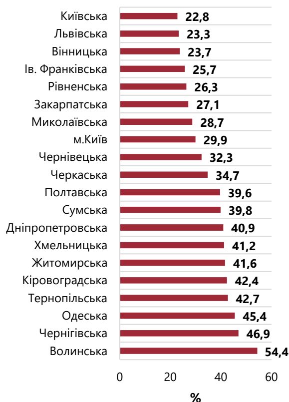
Рис. 3.18. Частка ветхих та аварійних мереж централізованого водовідведення (у % до загальної протяжності мереж)
