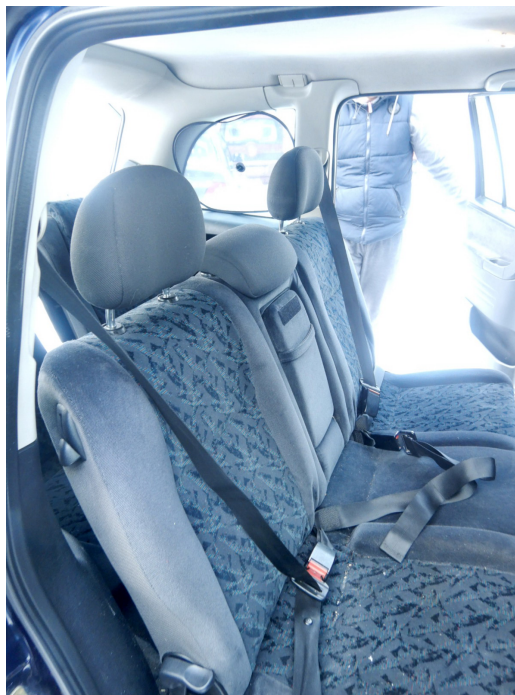
Рисунок 1. Середнє місце пасажира, обладнане двохточковим ременем безпеки.
