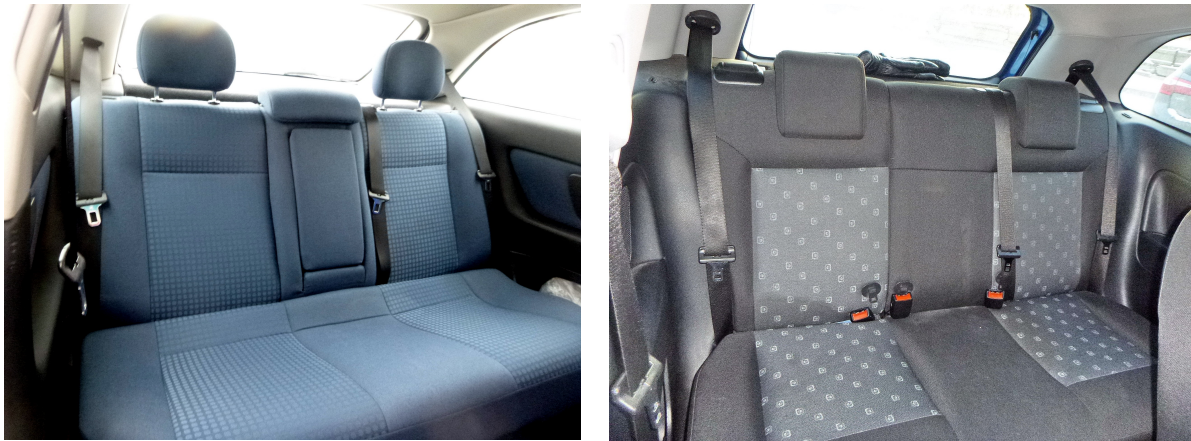
Рисунок 3. Середні місця пасажира, обладнані трьохточковими ременями безпеки.
